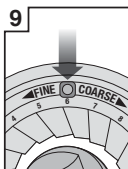
9 Zorg dat het cijfer is uitgelijnd met de handgreepopening
