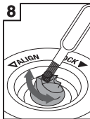
8 Maak onderste maalelement schoon met een borstel
